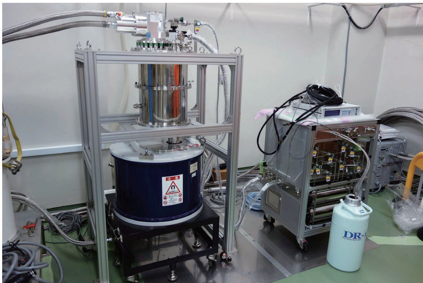
図1: 共用備品の無冷媒希釈冷凍機。6テスラ無冷媒超伝導マグネットとの組み合わせ。
