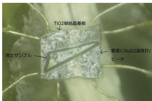
図4 パルス磁場用高速比熱測定セットアップ。自作試料台とその周辺。ここでサンプルは量子磁性体。
